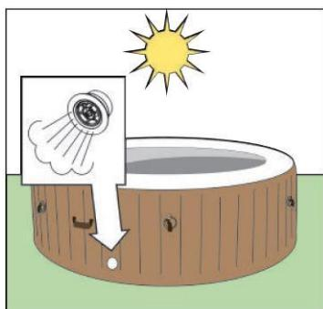
Nakon izlaganja suncu i toplom vremenu, vazduh se širi i pritisak raste. Ventil za otpuštanje pritiska omogućava ispuštanje viška vazduha.
