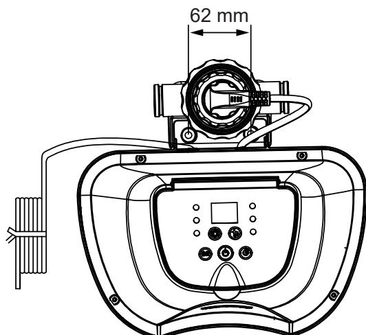
1. Rupe za montažu su 6.4 mm u prečniku i raspoređene na 62 mm.
