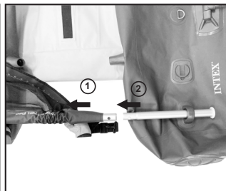
5. Umetnite kratku „2-delnu montažnu cev“ kroz drugu stranu montažne rupe na trupu i u dugi komad montažne cevi. Vodite računa da dugme sa oprugom bude zaključano na svom mestu.
