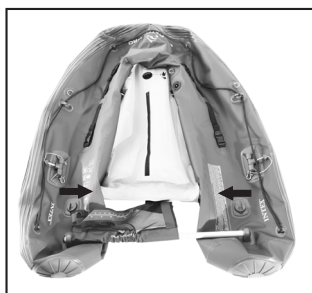
8. Vodite računa da „cev poda trupa“ bude čvrsto umetnuta u montažne spojnice tokom naduvavanja.
